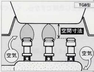
②当器種は釜土型タイプです。必ず不燃構造のステンレス製釜土、又は耐火モルタル製釜土等の中にセットしてご使用下さい。尚、バーナーへットから鍋底までの空間寸法は下記の通りです。この範囲内で設置して下さい。
