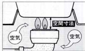
③釜土の中の燃焼室部分は給排気が充分にとれる構造(出来ればバーナーを置く底部は、下からの空気の流通が充分とれる開放構造)でバーナーの管吸器部分からコック等は釜土の外に出るように設置して下さい。
